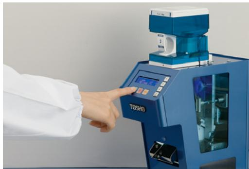
Blade専用力セットにカットする錠剤を入れ、Bladeにセット。あとはカット数を入力してスタートするだけの簡単操作。Bladeが自動的に錠剤を採寸して、最適なカット動作を実現します。※専用力セットは、錠剤分包機でもご使用いただけます。
